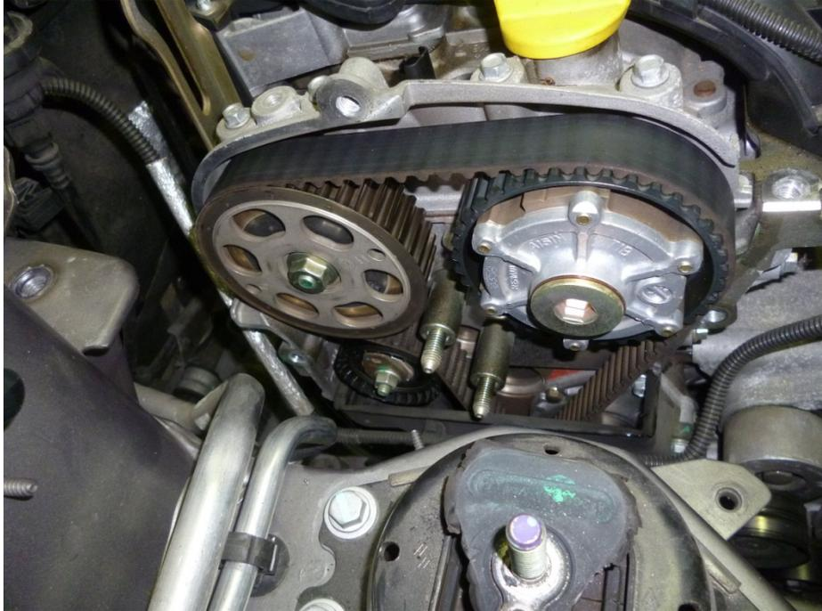
14. Retirer les 3 vis de 7 de la protection thermique qui se trouve sur le carter inférieur de distribution et le déposer.
