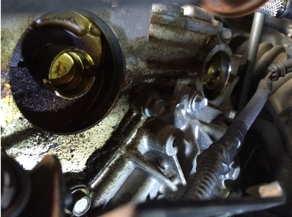
17. Déposer la vis de calage du vilebrequin à côté de la jauge d'huile avec la douille TORX E14. Note : Dans la photo ci-dessous, j'ai remplacé la vis torx par une vis BTR pour ne pas être embêté la fois suivante.
